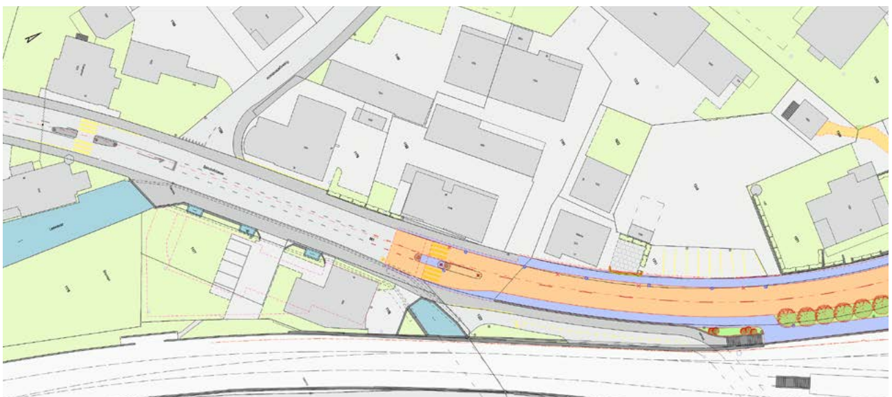
Abbildung 8: Bahnhofstrasse mit neuem Trottoir
