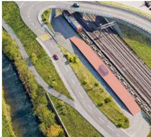
Für die Bedürfnisse des SBB-Unterhalts wird eine Instandhaltungsrampe unter dem Knoten Stegstuden realisiert. Vorübergehend wird die Rampe zusätzlich dem Freiverlad zur Verfügung stehen, bis angrenzend an das Zeughausareal in Seewen ein neuer regionaler Freiverlad realisiert wird.
