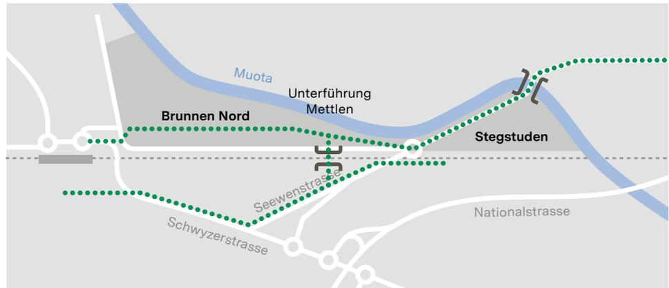
Abbildung 11: Radwegführung «Hochkreisel» unabhängig der Basis- und Groberschliessungsstrassen.
